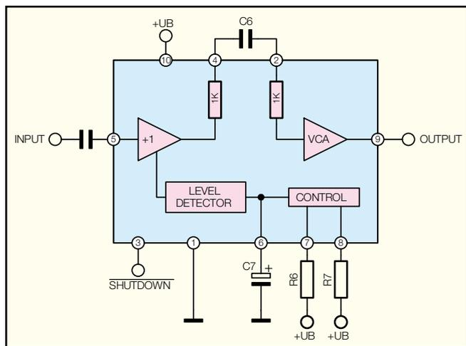
**Bild 2: Das Blockschaltbild des SSM2167**
